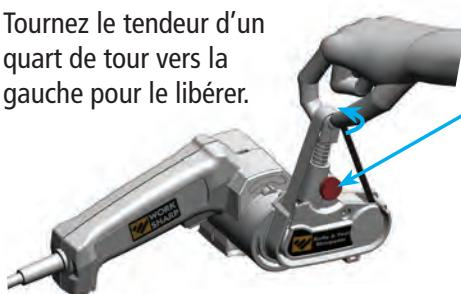
**REMARQUE :** Utilisez le bouton rouge sur la cassette d'affûtage pour régler l'alignement de la courroie. La courroie doit être centrée sur les trois poulies.
